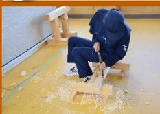
軸組構造部材（在来木造住宅の土台・柱・桁等の主要な骨組み）を加工し組み立てるための技術を習得します。
