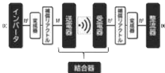
図 2 ワイヤレス給電回路のブロック図
