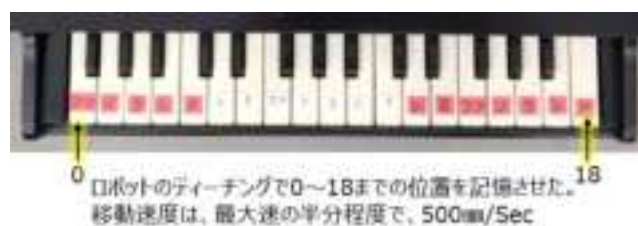
図 9 ピアノ音階とロボットティーチング位置
