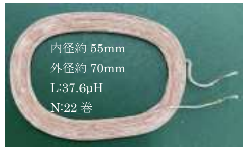
図 9 受電コイル(電車用)
