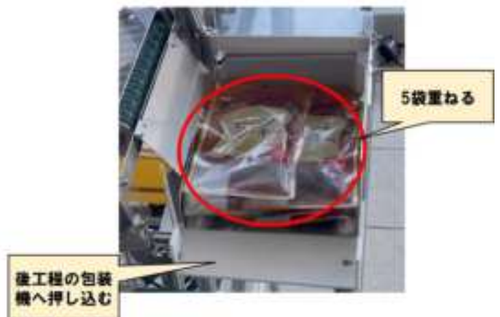
図 9 シリンダーによる製品の押し込み機構
