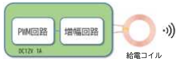
図 3 給電回路の概略図
