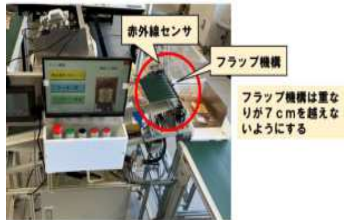
図 8 フラップ機構による高さ制限をクリア
