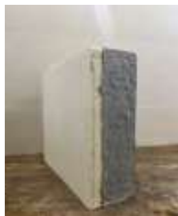
図 8 RC造試験体
