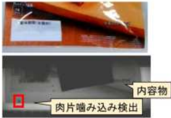
図 6 赤外線による検査画面
