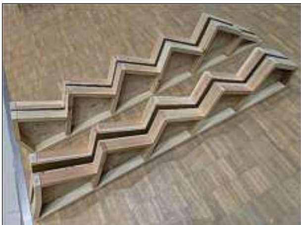
図9 側面パネル4~8段(手前)、9~13段(奥)
