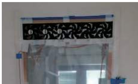
図4 実験住宅に設置した建具一体型空調扇
