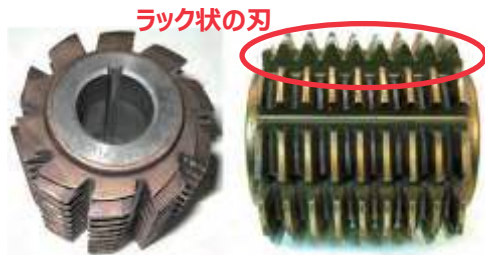
図3 切削工具「ホブ」の外観 1)
