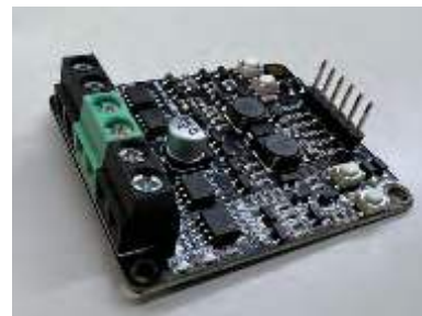
図 7 モータドライバ (MDD3A)
