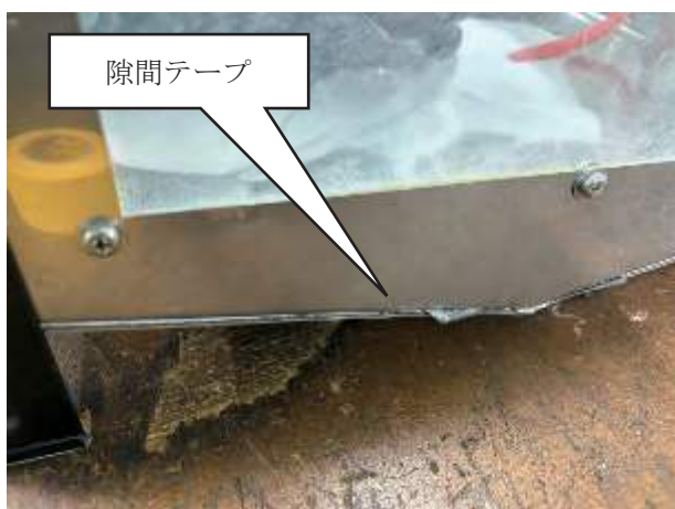
図5 接合部の漏れ対策
