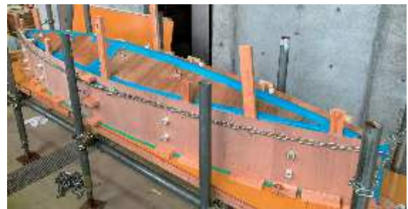
図5 2024年度コンクリートカヌー型枠
