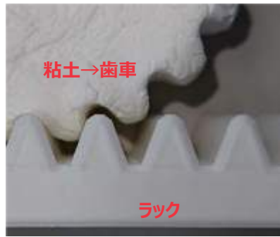
図2 ラック形状から粘土を歯車形状にした例
