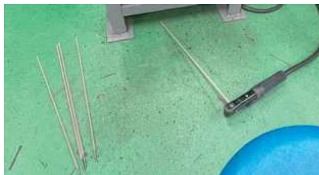
図 1 作業中断時における溶接棒とトーチ
