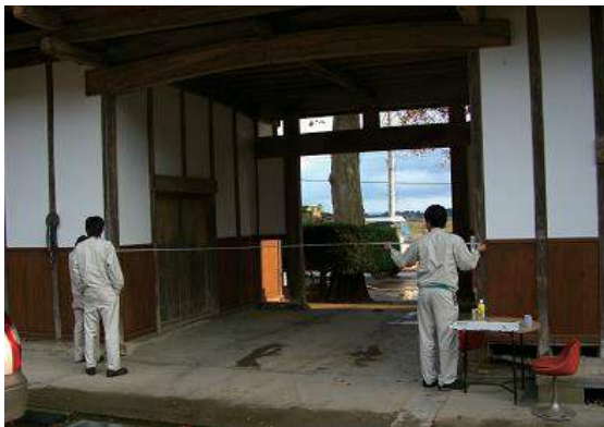
図3 通り門水平基準実測調査
