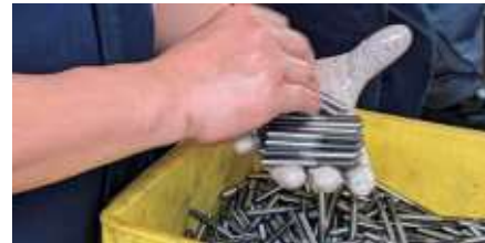
図 1 手作業によるタップの整列
