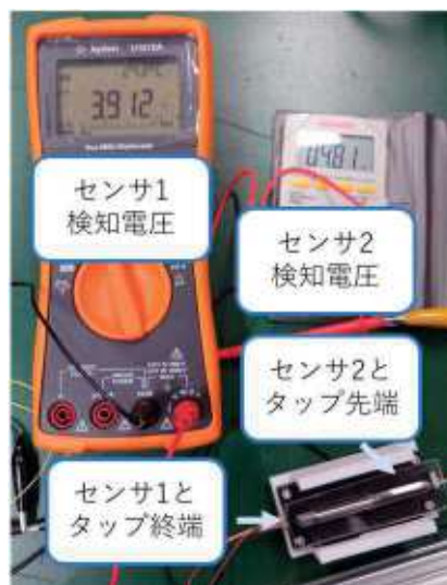
図 7 近接変位センサによる基礎実験
