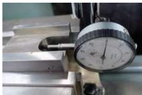
図2 ダイヤルゲージを用いた溝深さの測定
