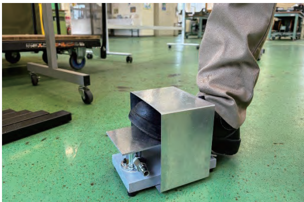
図8 土台に固定したフットペダル
