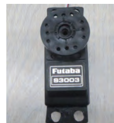
図 4 使用したサーボモータ (S3003)
