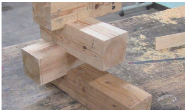
図 2 試作した仕口(2012/11/09)
