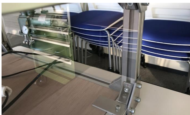
図7 取り付けしたアルミプレート
