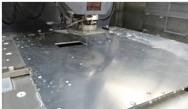
図4 窓を製作している様子
