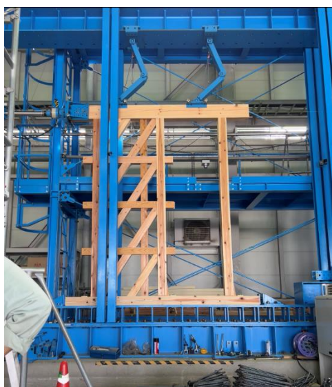
図2 面内せん断試験装置
