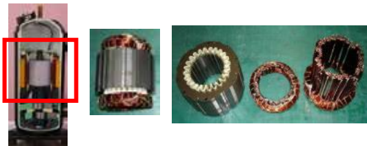
図 1 コンプレッサ内部構造と内部モータ分別例
