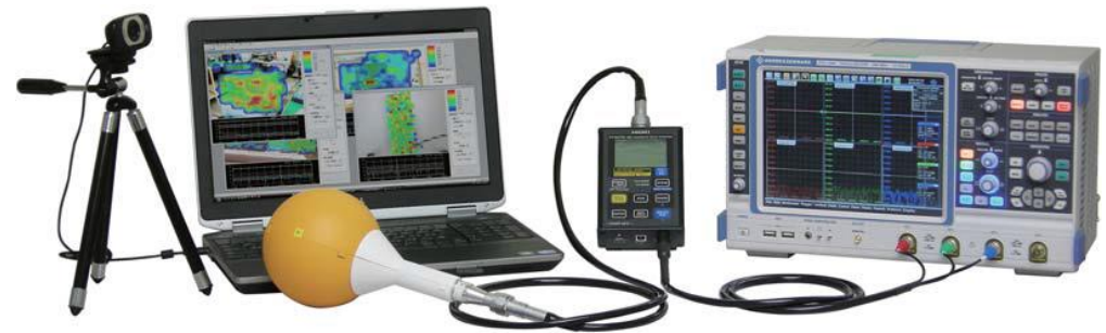
空間電磁界測定器による基板電磁界の実測
