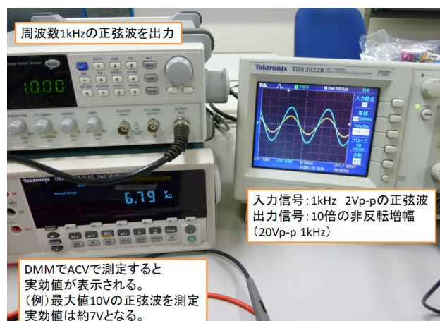
非反転増幅回路 計測例
