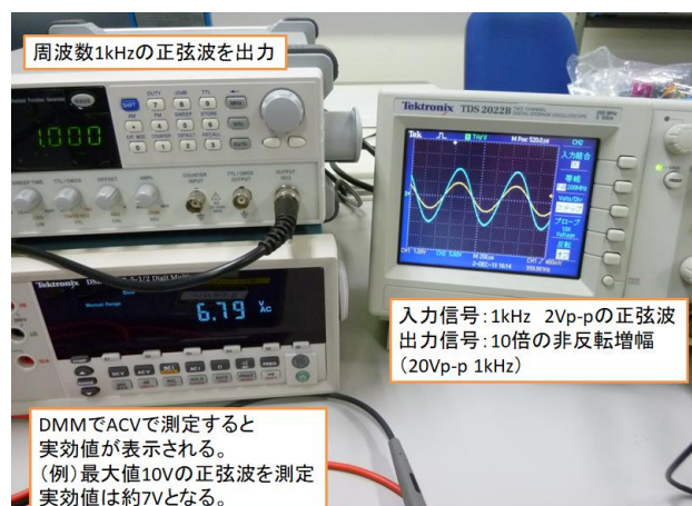
非反転増幅回路 計測例
