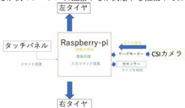
図1 走行ユニットのシステム構成
