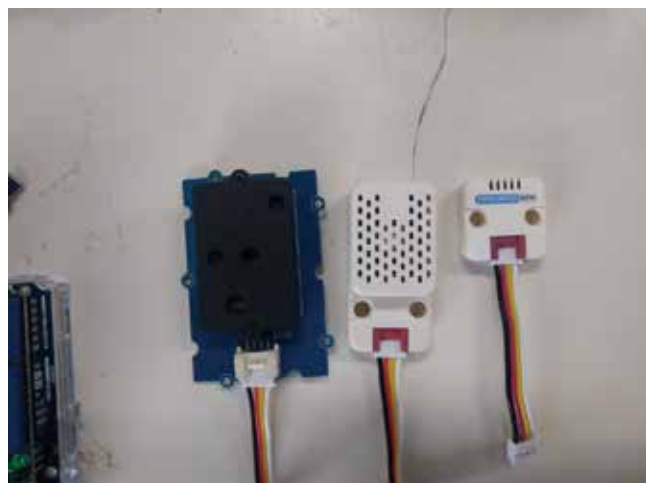
図2 CO2 センサ (左から SDC30, SDC40, SGP30)
