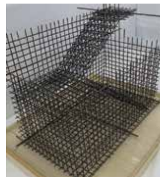
図12 階段配筋模型
