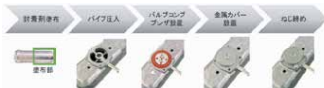
図1 シリンダヘッドカバー組み立て工程
