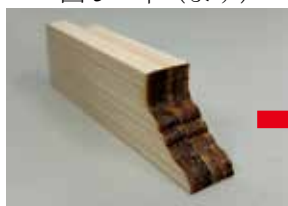
図7 レーザー加工の断面の調色
