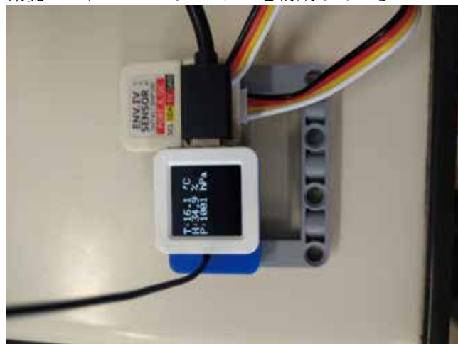
図4 ES920LR3 による環境データの LoRa 通信
