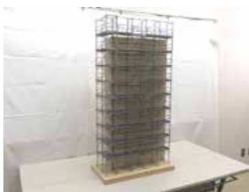
図5 組立てた足場模型 (全体)
