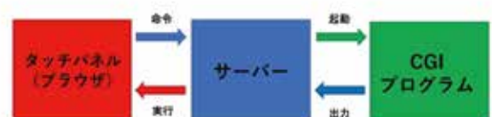
図3 プログラム送信用サイトのシステム構成
