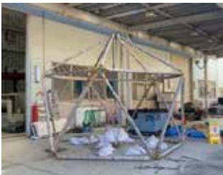
図 10 試験 1 の 300N 载荷後
