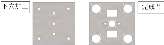
図 6 加工した昇降台
