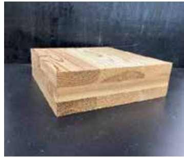
図 12 自作 CLT の構成
