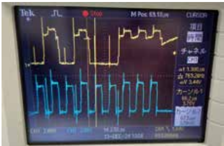
図 5 不安定な信号の波形
