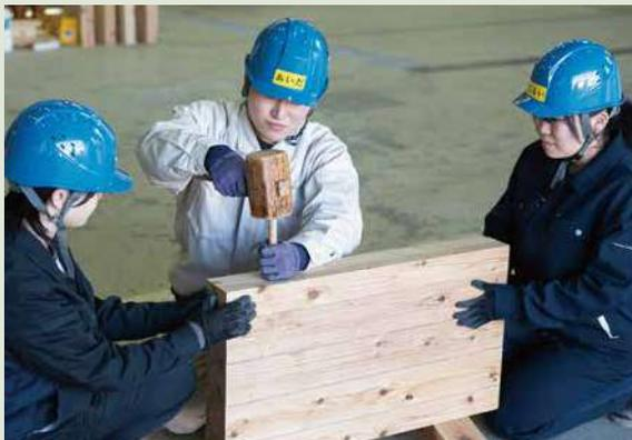
DLTパネルは、木材を接着剤や釘などを用いず木ダボのみで接合する新しい建築パネルです。このパネルは床・壁・屋根などの構造材や、木の風合いを活かした現しの意匠材、さらには木の素材感を活かしたインテリアまで、多彩な用途に活用できるものです。このパネルを木造住宅のリフォーム時に柱・はりなどにはめ込むことによって建物の耐震性がどのように向上するのかを実験を通して開発を進めています。
