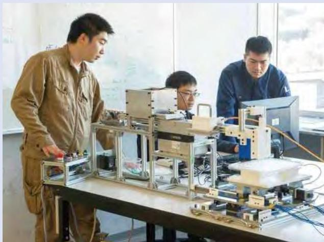
本テーマでは、プレス加工された微細なサンプル製品を、画像検査した後、出荷用トレーに投入する装置を製作しています。依頼企業は微細なサンプル製品を顕微鏡で検査、手作業で出荷用トレーに投入していたため時間と労力を費やしていました。私たちは、この課題をサーベイランスシステムや自動投入装置で負担軽減するなど改善することで作業を自動化し、省力化及び時間短縮の実現を目指す装置を開発しています。
