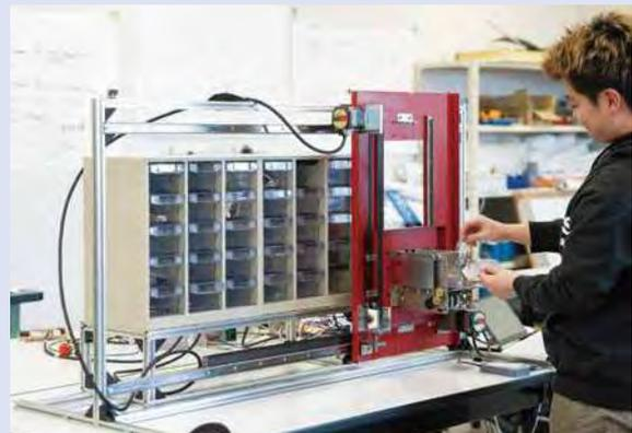
ワイヤーハーネスの製造を行っている近隣企業とのテーマです。千種類以上の治具の中から対応治具を手作業で探し出しているため、作業者の負担を減らしたいとの要望を受けました。そこで『選択された治具を自動で取り出し、収納する治具保管設備』の開発をすることにしました。これにより、作業者の熟練度に関わらず容易に治具が取り出せるようになり、作業者の負担軽減と作業時間の均一化が期待されます。
