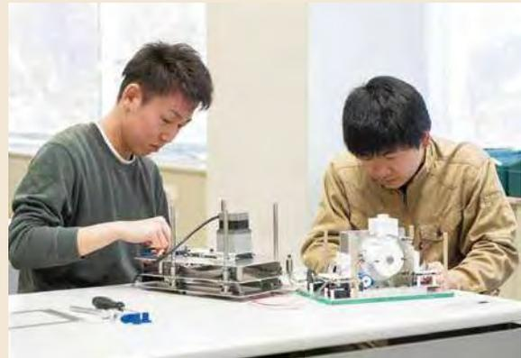
包装材製造会社のS社では、農産物等のフィルム包装資材の製造・販売を行っています。このフィルム包装資材をまとめて梱包する袋もフィルム素材であり、出荷用に製品情報のラベルを貼り付けます。この作業は、フィルムが分けづらいためにヒューマンエラーを起こしやすい作業です。本テーマでは、ラベルと袋をセットし、生産枚数を指定することでラベル貼り作業を行う装置と出荷用の袋の製造管理システムを開発しました。
