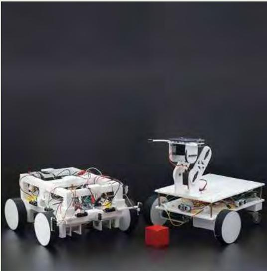
ロボット競技会に向けた自律型ロボットの製作
