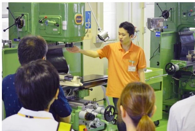
機械加工実習室で旋盤やフライス盤の説明をしています
