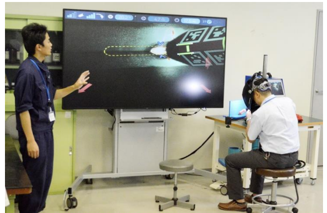
AR技術を使った溶接シミュレータ。日本ではまだわずかしが整備されていません
