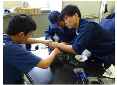
機械保全実習。ラジコンを題材として、部品の材質やメンテナンス方法の違いで速度の変化が生じるかを検証します。
