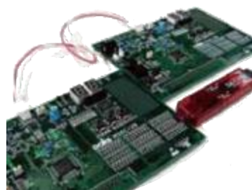
開発用ターゲットボードと簡易CANアナライザ
