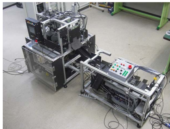
図6 にんにく仕上げ装置と検証装置の一体化
