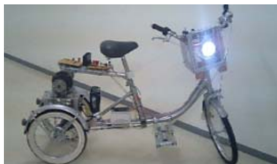
図3. 回生・充電システム付き電気バイク
