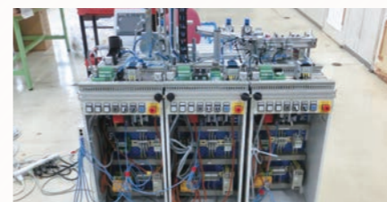
「メカトロニクス」職種 競技工場の自動化ライン模擬装置
