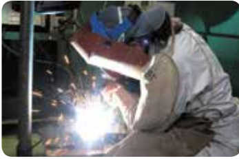
炭酸ガスアーク溶接作業
