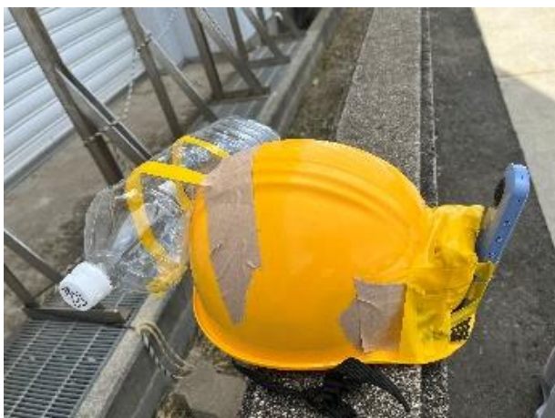
図3 カメラとペットボトルを固定したヘルメット
