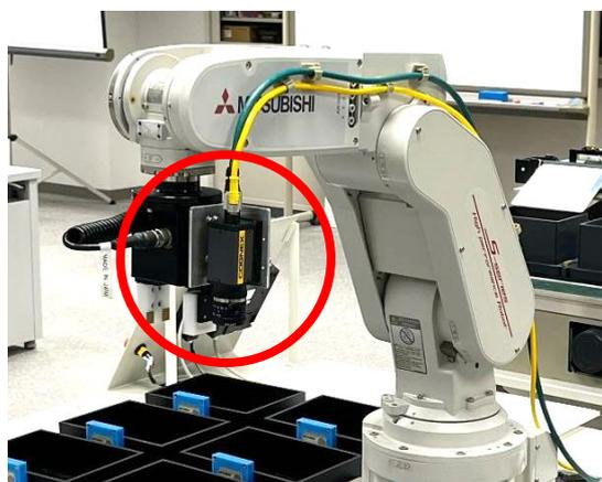
図2 ビジョンセンサーの取り付け図
