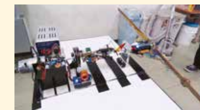
裏側から。回転する本体に大半の制御機器が付いている。
