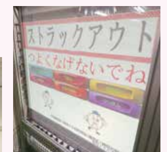
ゲームモード。裏のタッチパネルで操作、バックからプロジェクタで投影している。
