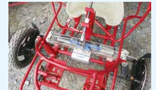
ハンドルとタイヤの接続は棒状の歯車(ラック)を使用している。滑らかなハンドル操作が可能となった。
