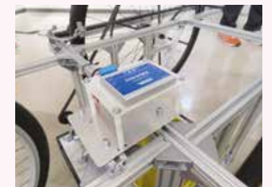
このマシンの心臓、昇圧回路。単3電池の電圧を人を動かすまでに昇圧する!
