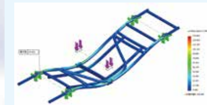
構造解析で強度を分析する。車体は全てアルミニウム。
