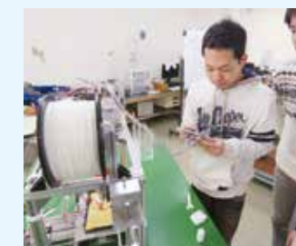
液晶パネルで操作。形状データはパソコンから取り込める。
