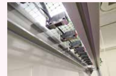
画面の端には赤外線センサがびっしり。
