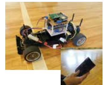
ラジコンカーとコントローラー (箱の傾きで操作)
