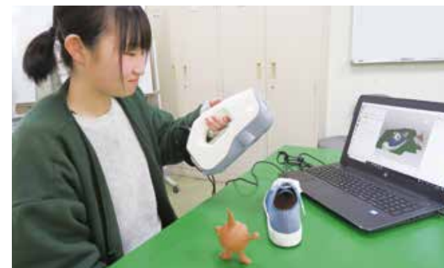
実物の精度を三次元測定機で計測
