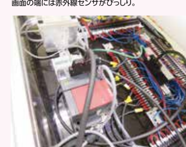
マシンの裏側。赤外線センサの情報は全て中央の赤色のシーケンサーという装置に送られ、制御されている。
