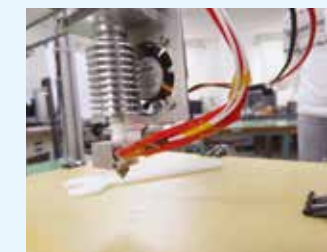
樹脂供給のヘッドは高熱となり、溶けた樹脂が下のテーブルに積層。テーブル自体が前後左右に動く。
