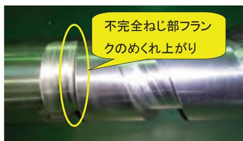
図 12 加工ねじフランクのトラブル
