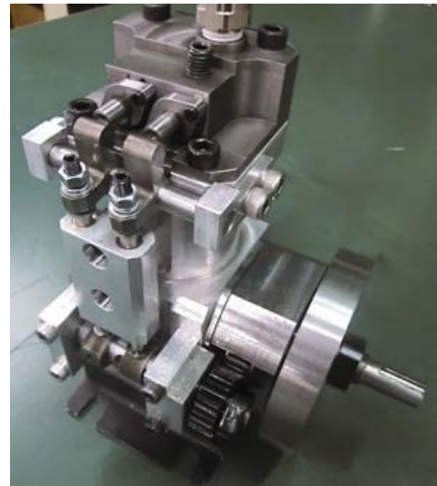
図4 動弁機構を備えた単気筒空気エンジン
