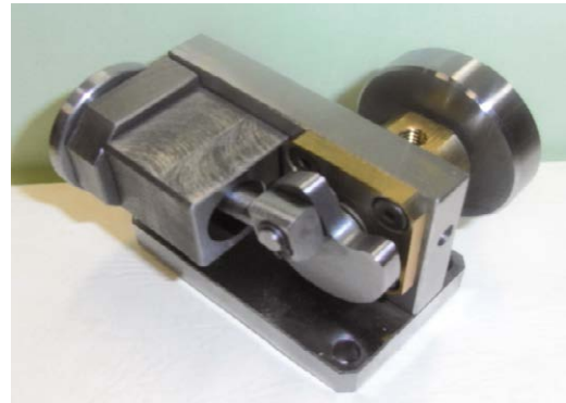
図2 出力軸バルブ式単気筒空気エンジン
