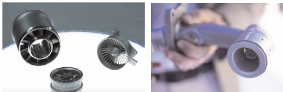
図8 3Dプリンタで航空機エンジン部品製作 8)
